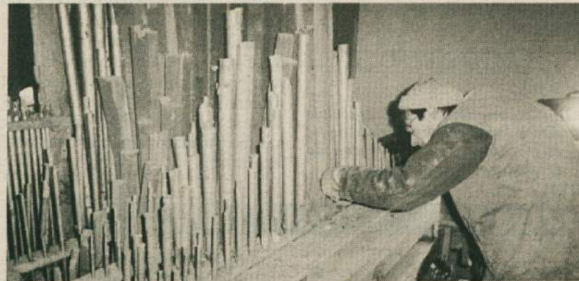
Restavrator Bogdan Černe je z vsjo pazljivostjo razstavil soteške orgle in jih od njih odpeljal v svojo delavnico, kjer jih bo pomladil in jim vrnil izgubljeni glas. Na sliki: odstranjevanje orgelskih kovinskih piščalci, ki bodo še uporabne.
